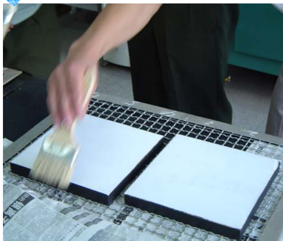
使用橡胶处理剂正在处理 PTFE 表面
